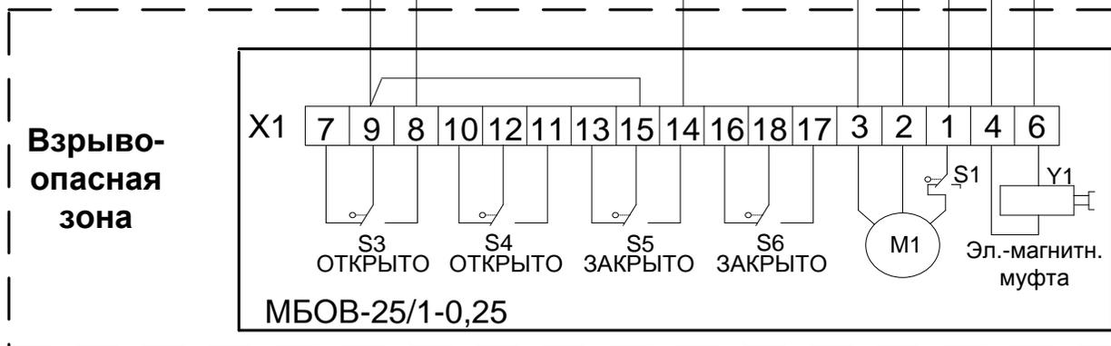
Рис.1 Схема электрическая подключений электромеханизма МБОВ-25/1-0,25 с блоками БУПУ и БА3-01М
